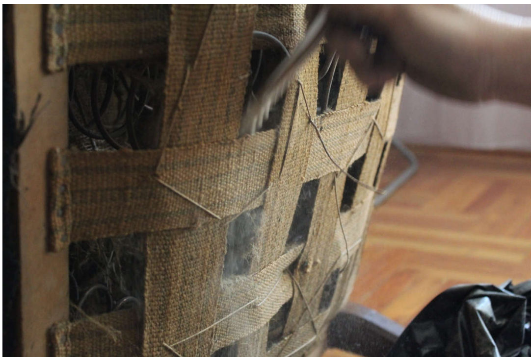
Mechanikus tisztítás a grádliszalagok között, a bútor belsejében
